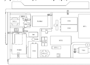
Внутреннее устройство электрического блока управления (для инвертора)
